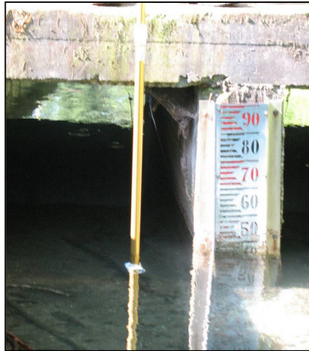
Foto 2: Sezione dell'emissario Acquanera utilizzata per le misure di portata.
