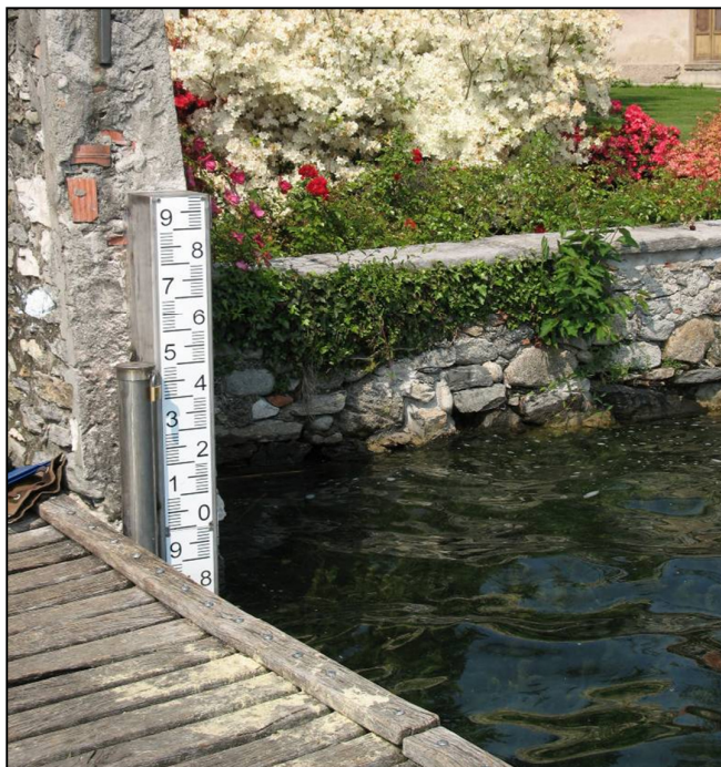
Foto 1: Asta idrometrica installata sul Lago di Monate.
